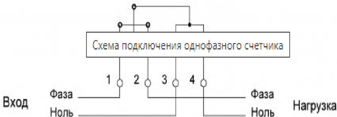
**Рисунок 11 - Схема подключения однофазного счетчика**
