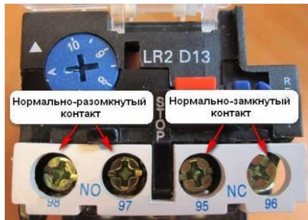
Рисунок 27 - Тепловое реле, вид спереди
