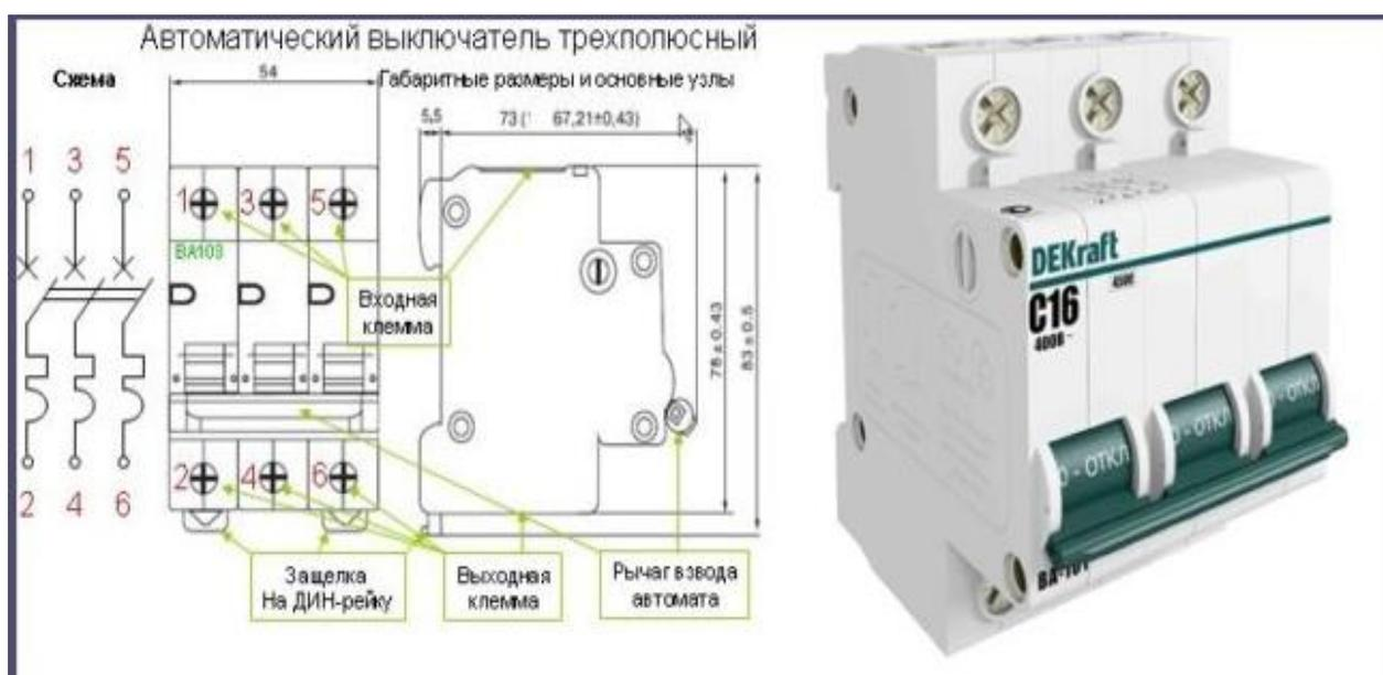
**Рисунок 4 - Трехполюсной автоматический выключатель**
