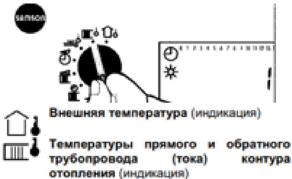
**Рисунок 30 - Регулятор контроллера**
